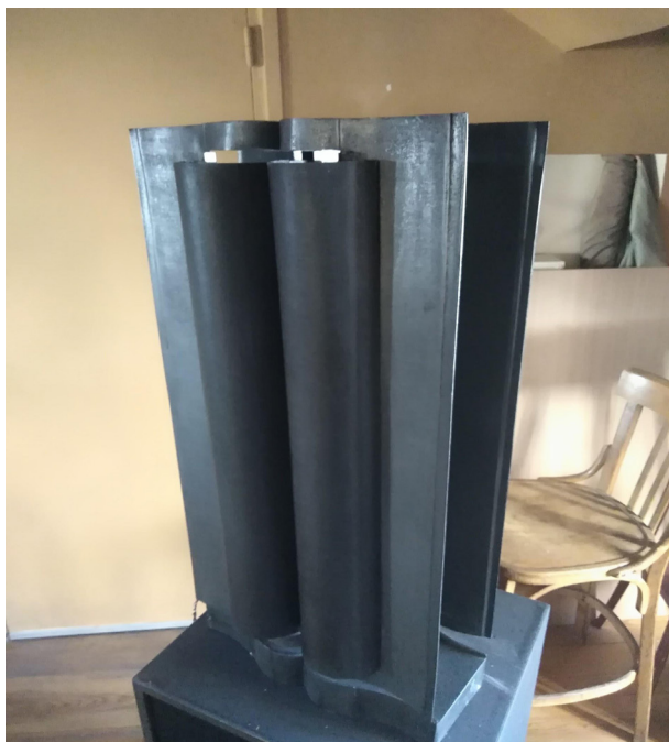
Figure 6. Prototype de haut-parleur Vertex. La caractérisation du matériau a été réalisée à l'aide de mesures effectuées avec un marteau d'impact et un vibromètre laser
