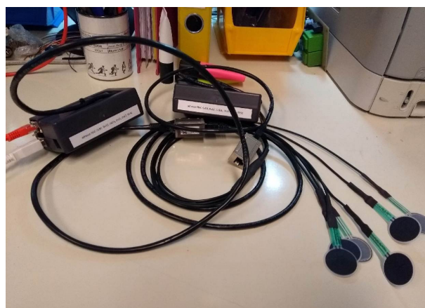
Capteur de pression développé pour le spectacle Thinking Things avec transmission Ethernet / OSC
