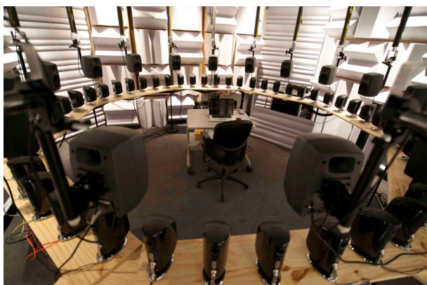
Dispositif audio du CIRMMT (Montréal) utilisé pour les expériences avec des sources sonores tournant à très haute vitesse autour des auditeurs
